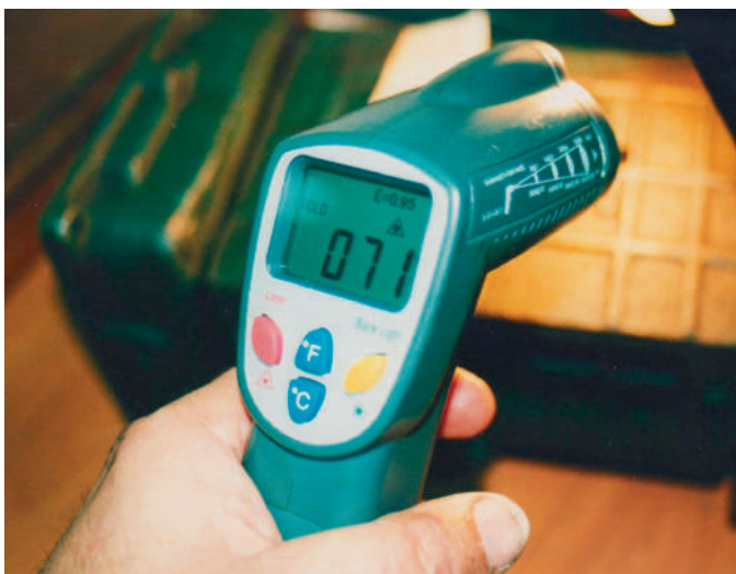
Рисунок 2. Примеры контроля температуры дистанционным пирометром при тепловой обработке полимерных составов на деталях (картеры, валы, полуоси), не входящих по габаритным размерам в сушильные шкафы.
