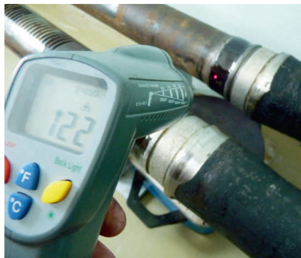
Рисунок 2. Примеры контроля температуры дистанционным пирометром при тепловой обработке полимерных составов на деталях (картеры, валы, полуоси), не входящих по габаритным размерам в сушильные шкафы.
